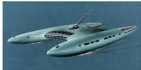
Le navi idrodinamiche da trasporto marittimo permettono di viaggiare efficientemente ad alta velocità; sono energeticamente efficienti e forniscono la massima comodità e la massima sicurezza ai passeggeri. Vengono fabbricate con materiali compositi di lunga durata, la cui superficie esterna consiste di una sottile lamina di titanio che richiede una manutenzione minima. Porzioni del ponte superiore si aprono con un sistema a scorrimento quando il clima lo permette.
