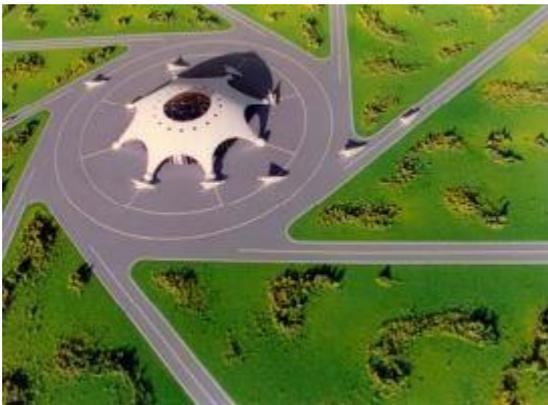
La cupola centrale di questo aeroporto contiene i terminal, le strutture di manutenzione, i centri di servizio e gli alberghi. Le piste sono disposte in una configurazione radiale che consente agli aerei di decollare facilmente nella direzione dei venti prevalenti e di evitare pericolosi atterraggi per via dei venti trasversali. Le stazioni di emergenza al limite delle piste sono completamente equipaggiate di attrezzature antincendio incorporate e di congegni per gli arresti di emergenza.
