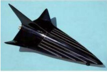
Questi velivoli con configurazione a delta sono controllati con mezzi elettrodinamici eliminando la necessità di alettoni, montacarichi, timoni, spoiler, flap o qualsiasi altro tipo di controllo meccanico. In più, oltre a fornire le migliori qualità aerodinamiche e di manovrabilità, questa tecnologia innovativa serve anche da sistema antigelo. In caso di atterraggio di emergenza, il combustibile viene espulso per prevenire gli incendi.
